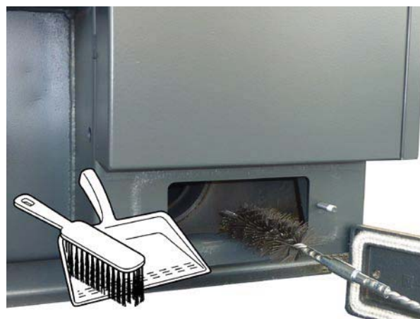
Vorführung der Reinigung des Rauchkanals mit Drahtbürste.
